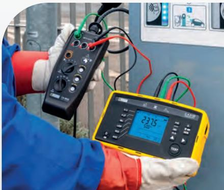
Messung der Ausgangsspannungen einer Ladestation mit FI-Schutzschalter Typ A während des Ladevorgangs
