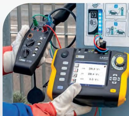
Messung der Ausgangsspannungen einer Ladestation mit FI-Schutzschalter Typ B / EV 6mA während des Ladevorgangs
