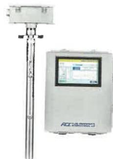
La série **MT100**, distribuée en France par Engineering Mesures, est un débitmètre massique thermique multipoint de type insertion spécialement conçu pour les cheminées d'évacuation et le lot CVC. Le MT100 de FCI utilise jusqu'à huit points de détection de vitesses dans le flux d'écoulement et calcule la valeur moyenne, ce qui permet une mesure de précision et une bonne répétabilité. Contrairement à d'autres débitmètres de technologie différente, le MT100 ne comporte aucune pièce mobile ou
