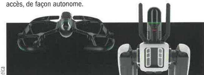
Le scanner Laser BLK Arc de Leica Geosystems peut être embarqué sur un robot, et le modèle BLK2Fly est en fait un drone.
