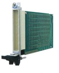
Le module est conçu pour le routage des signaux dans les systèmes de test automatique et d'acquisition de données. Il cible les applications pour lesquelles la confirmation de l'état du canal est requise avant l'application du signal de test », explique Steve Edwards, chef de produit de commutation chez Pickering Interfaces.
