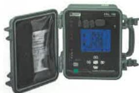
2 nouveaux modèles viennent compléter la gamme des enregistreurs PEL100 de Chauvin Arnoux, Le PEL106, tout-terrain, IP67, et le PEL104 pour les applications sur les moteurs électriques. Nouveaux modes de mesures,
