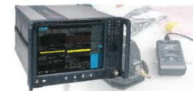
tions d'émetteurs grâce à la magnitude du vecteur d'erreur (EVM) et au logiciel d'analyse de signaux 5G NR. Les mesures de liaison descendante et de liaison ascendante de l'émetteur peuvent être lancées via un seul bouton de commande.
