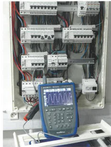
► Oscilloscope connecté Scopix pour les mesures dans un tableau électrique.
