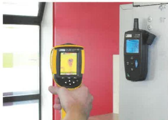
► Caméra thermique communiquant en temps réel et mesure de température et d'humidité.
