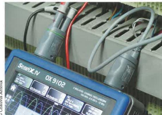
► Oscilloscope Scopix (Chauvin Arnoux) pour surveillance d'équipements électriques et électroniques.
