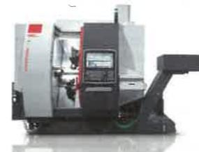
Cette plateforme d'usinage a été conçue pour agrandir considérablement l'espace de travail. Elle accueille une tourelle avec un grand rayon d'action susceptible d'intégrer une tour de type port-outils de 16 compartiments et d'augmenter la course sur l'axe Y de ±40 mm. Compacte, elle dispose d'un banc incliné de 72 degrés pour prendre en charge les tâches ergonomiques et l'évacuation optimale
