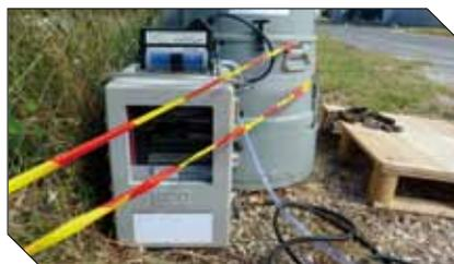
➔ Échantillonneur couplé à un débitmètre
