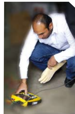
Relevé de mesure avec le C.A 8335 de la gamme Qualistar®
