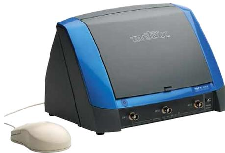
Les oscilloscopes MTX 3352 et 3252, ici avec leur écran rabattu, sont équipés en standard d'une liaison RS232 à 230 kbauds et de l'interface Centronics.
