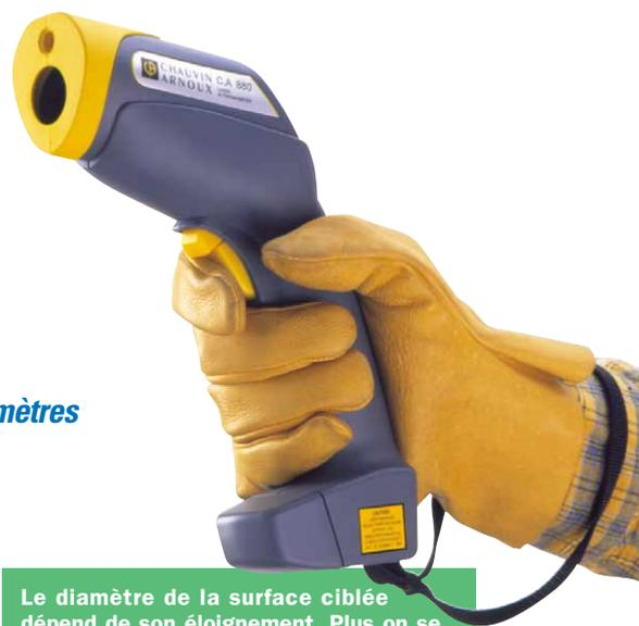
Le diamètre de la surface ciblée dépend de son éloignement. Plus on se rapproche de la cible, plus cette surface est petite et meilleure est la mesure. Ce rapport "distance de la cible / diamètre de la surface ciblée" est aussi appelé champ de mesure. Il se présente sous la forme d'un cône effilé, de 10 cm pour 1 m, qui double tous les mètres (approximation pour mémoire).
