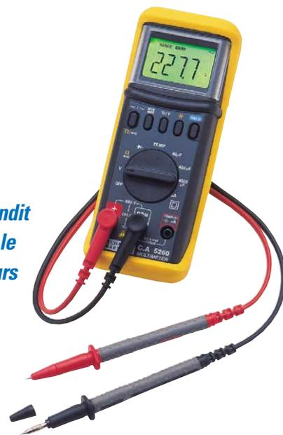
Les nombreuses fonctions du **C.A 5260** en font un appareil “multimètre/thermomètre” à la fois dédié et polyvalent : tension jusqu'à 600 V AC/DC, résistance jusqu'à 40 M $\Omega$ , capacité jusqu'à 4000  $\mu\text{F}$ , test de continuité, test de diode, enregistrement min-max, touche HOLD pour le maintien de la valeur affichée à l'écran, et bien sûr, toute la sécurité IEC 61010-1 CAT III 600 V.
