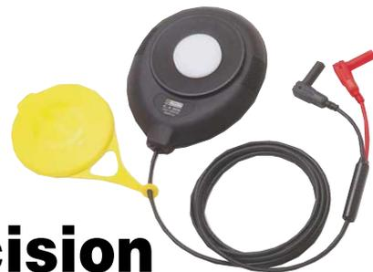
*La réglementation du travail, les normes de qualité dans la construction, définissent des niveaux d'éclairage minimaux pour les locaux publics, professionnels et à usage d'habitation. Les instruments nécessaires à ces mesures sont des luxmètres de qualité, précis et fiables, mais relativement onéreux. À moindre coût, la cellule luxmétrique C.A 808 permet de transformer votre multimètre numérique en un performant luxmètre, juste et précis.*
