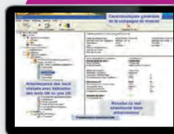
Un logiciel spécifique aux contrôleurs d'installation, livré en standard, permet une analyse simplifiée et rapide des mesures enregistrées. Il permet la récupération des données, le paramétrage de l'appareil, la personnalisation des campagnes de mesure avec transfert dans l'appareil, et l'édition de rapports.
