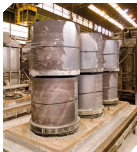
➔ Vue sur une base de four à cloche, avec ses 6 bobines d'acier après leur traitement thermique.
