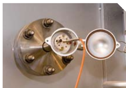
➔ Gros plan sur le capteur étalon introduit dans la gaine d'une canne pyrométrique avec étalonnage in situ .
