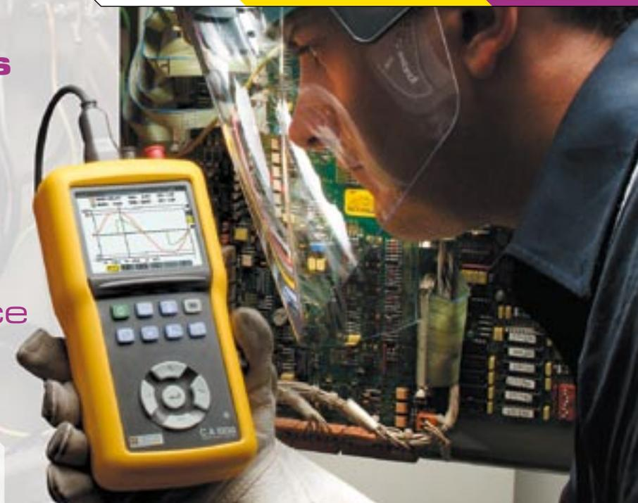
est assurée par l'intermédiaire d'un grand écran LCD couleur 1/4 VGA ou rétro-éclairé (en fonction du modèle) et permet un confort de lecture de l'utilisateur.
