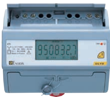
4 modules DIN pour le modèle "mono" contre 7 pour les "triphasés"
