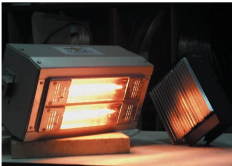
Les lampes infrarouges utilisées pour le séchage des peintures nécessitent une régulation de la puissance de chauffe très constante.
