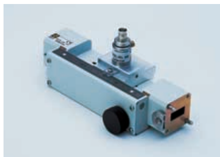
La ligne de mesure ORITEL LAF 100 est équipée, comme chaque composant, du système de fixation rapide EASYFIX™.
