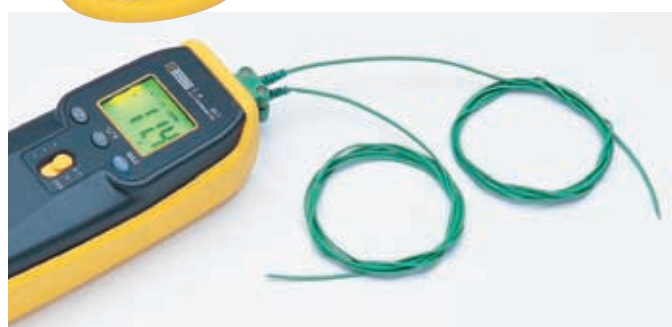
Le C.A 863 est livré avec 2 capteurs souples à couple K et le C.A 861 avec un capteur.
