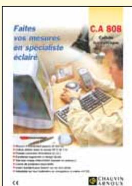
Ce capteur d'éclairement se connecte sur tout multimètre numérique, pour mesurer précisément la quantité de lumière par m<sup>2</sup>, jusqu'à 20 000 lux. L'outil idéal pour vérifier les conditions de travail par rapport aux seuils réglementaires ! Toutes les caractéristiques techniques sont détaillées sur ce feuillet.
