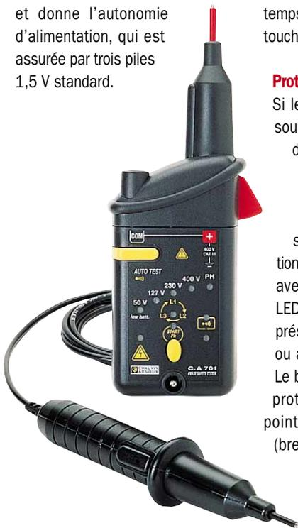
Le C.A 701 utilise une méthode originale "2 fils" pour le contrôle de rotation de phases.
