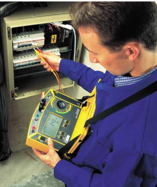
Le C.A 6115 permet de vérifier et de certifier intégralement la sécurité électrique des installations, selon les différentes normes européennes (IEC, VDE, BS, OVE, NIN/NIV,...), dont la NF C15-100.
